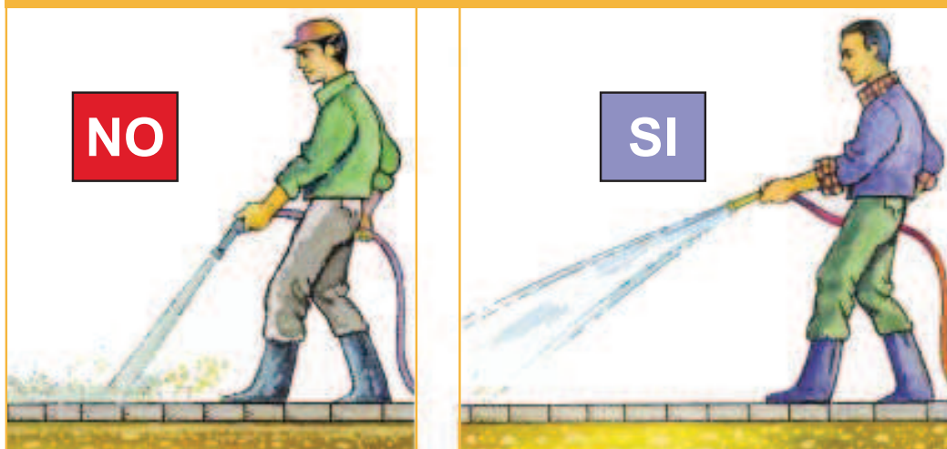
FIGURA 12. DEBE CUIDARSE EL ÁNGULO DE INCIDENCIA DEL AGUA AL LIMPIAR LOS ADOQUINES.
